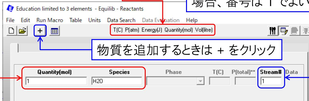
初期条件の設定。平衡状態は初期条件によらない(例、初期条件が氷でも気体でも 25 °C、1 atm における平衡状態は水)ので、平衡状態を求める目的ではチェックしない。反応前後の熱力学量の変化を計算するときはチェックして相(Phase)や温度(T(C))を入力する。初期条件を設定しない場合、結果に影響があるのは元素の量のみ。H<sub>2</sub>O の代わりに H<sub>2</sub> + 0.5 O<sub>2</sub> と入力しても同じ結果になる
